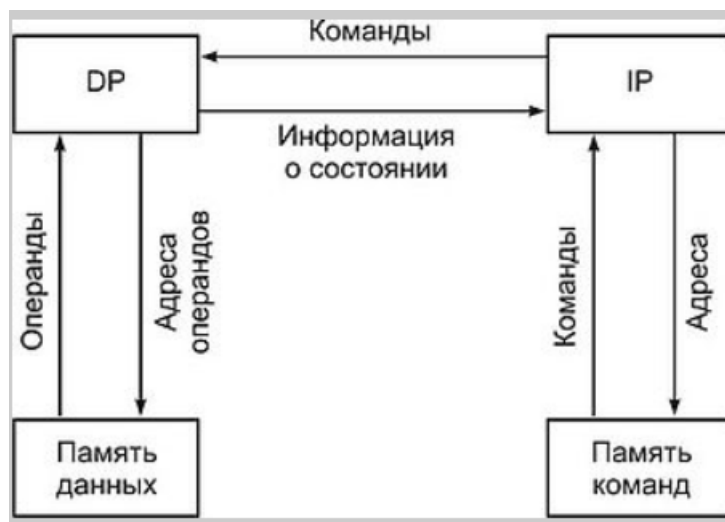
Рис. 2.5. Структура традиционной фон-неймановской архитектуры: ЭР — процессор данных; ГР — процессор команд
