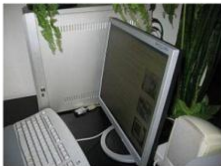
Искажение изображения на ЖК-мониторе при большом угле обзора
