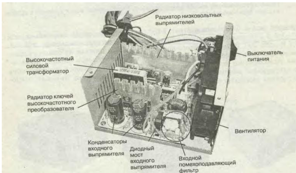
Рис. 2.2. Блок питания со снятой защитной крышкой корпуса Размер блока питания определяется конструкцией корпуса.
