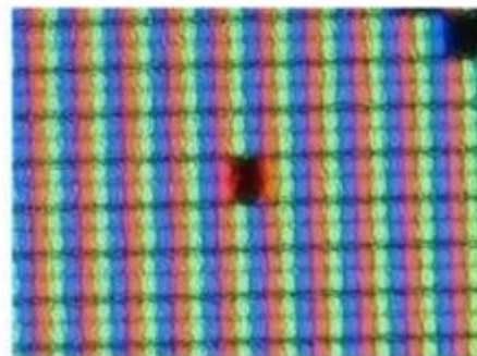
Макрофотография типичной жк-матрицы. В центре можно увидеть два дефектных субпикселя (зелёный и синий).
