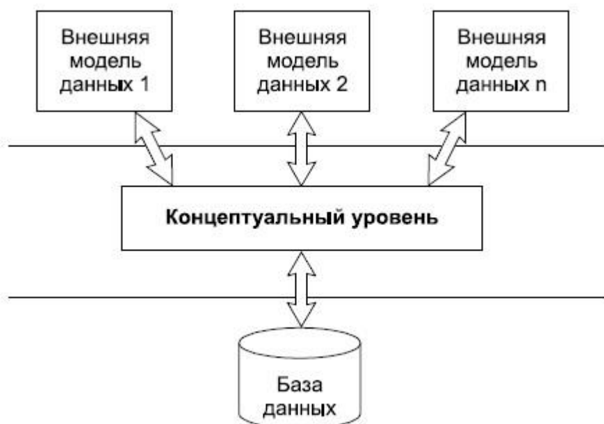
Рисунок 5 - Трехуровневая модель системы управления базой данных, предложенная ANSI
