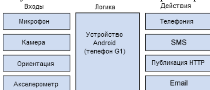
Рисунок 2. Блок-схема Android-ориентированной системы датчиков
